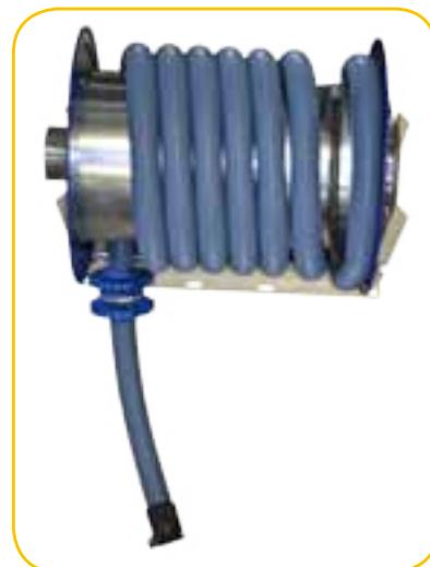
Gli arrotolatori per tubazioni flessibili delle serie Cleaning, sono macchine progettate per la pulizia professionale degli autoveicoli. Il tubo flessibile può essere scelto tra due sezioni (Ø50mm e Ø60mm) e due lunghezze (10m e 15m) a seconda delle vostre esigenze e applicazione. L'aspirazione avviene tramite un impianto centralizzato.
