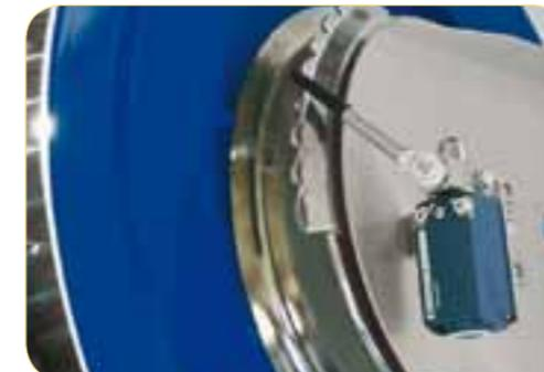
Microswitch di partenza automatica della turbina tramite srotolamento della tubazione.
