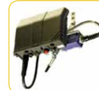
Microswitch di partenza automatica della turbina con comando via radio (senza fili).
